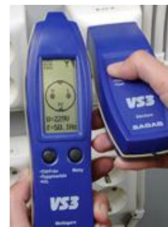
Angiver placering af fase, nul, jord samt værdien af spænding og frekvens
