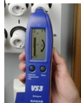
Detektere og angiver berøingsfrit hvilken fase der måles på, L1, L2, L3
