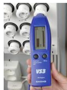
Finder nemt og hurtigt den sikring som senderen er forbundet til.
